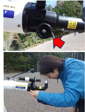
※もし、目標がファインダーの中心とズれていたら、ファインダー横の2本の調節ネジを回し、目標が中心になるように微調整します。
